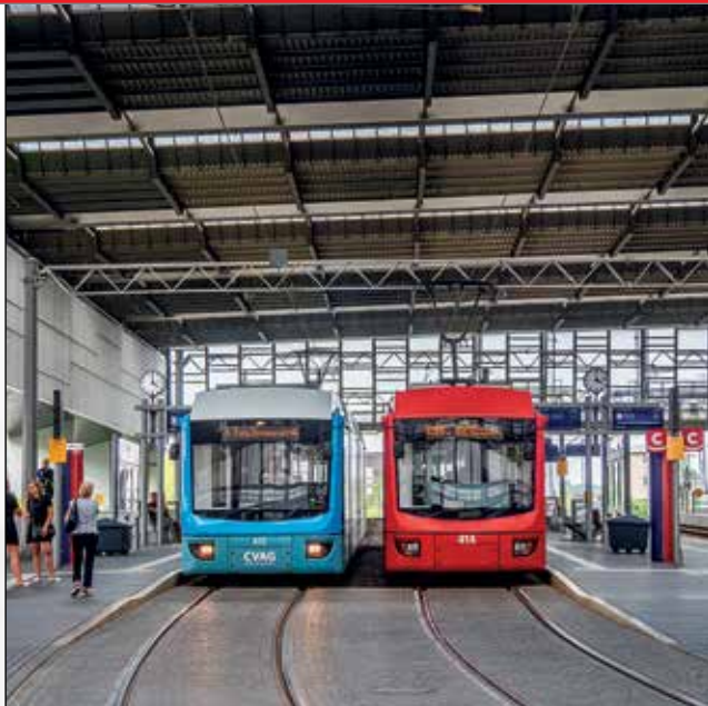
▲ Variobahnen am Chemnitzer Hauptbahnhof: links eine nur für den Straßenbahnbetrieb zugelassene Bahn der Chemnitzer Verkehrs AG, rechts eine für den Mischbetrieb Straßenbahn/Eisenbahn modifizierte Variante der City-Bahn Chemnitz. Sie benötigt eine Oberleitung.
